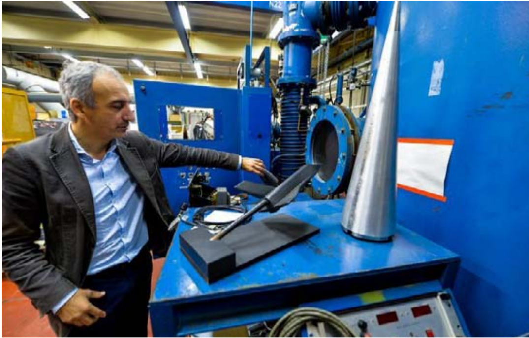
LongShot peut générer des écoulements de gaz jusqu'à 15 fois la vitesse du son. © PIERRE-YVES THIENPONT.
