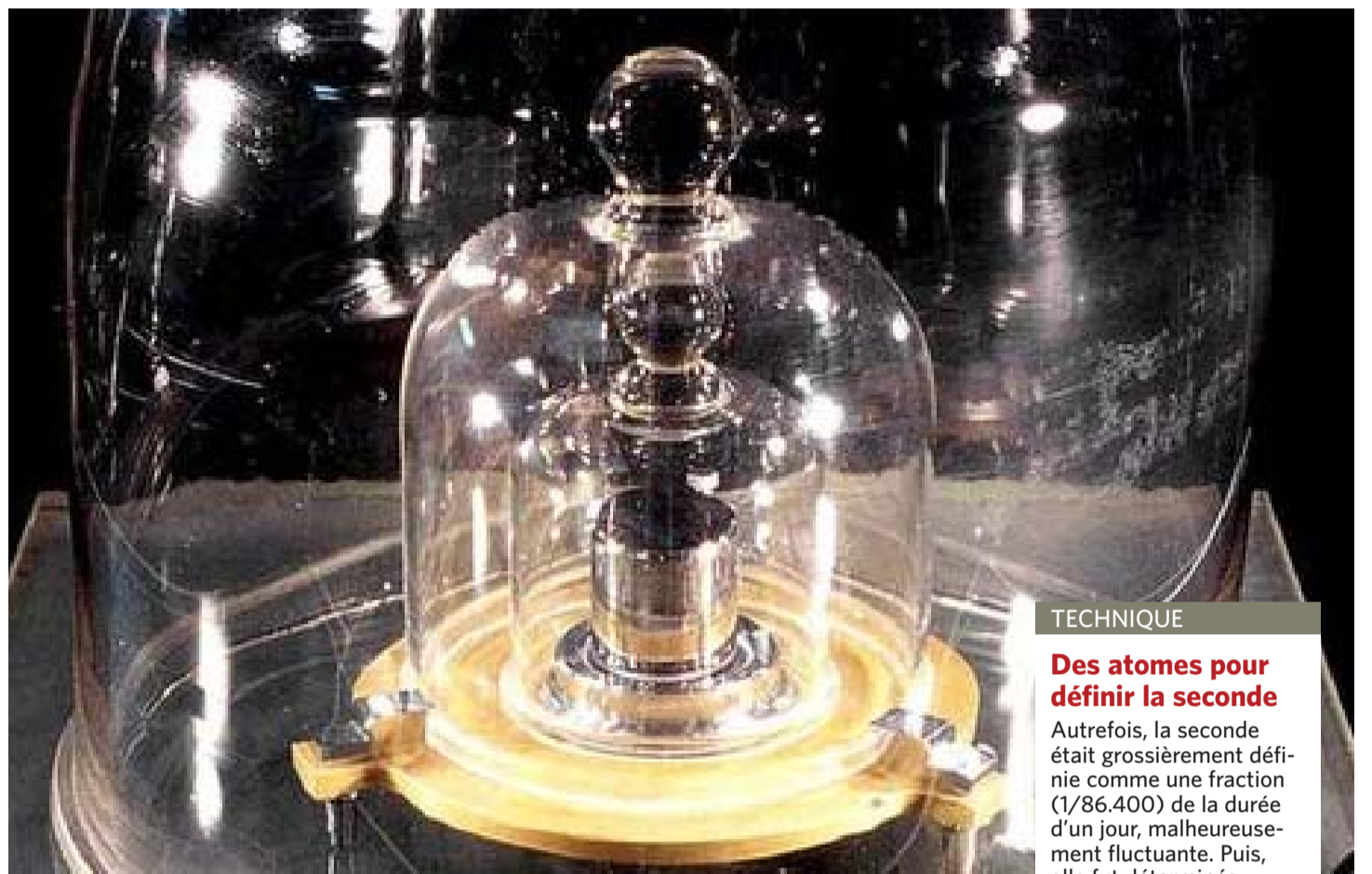
Depuis 1889, le kilogramme est défini par celui qu'on appelle « Grand K » : un cylindre composé à 90 % de platine et à 10 % d'iridium et conservé sous une triple cloche de verre près de Paris. © AFP.
