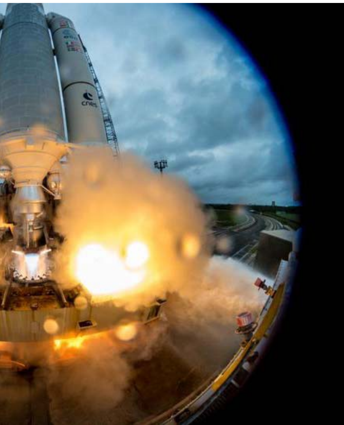
Au décollage, plus des deux tiers du corps de la fusée, haute de 47,4 m, sont gorgés de carburant. © STEPHANE CORVAJA.
