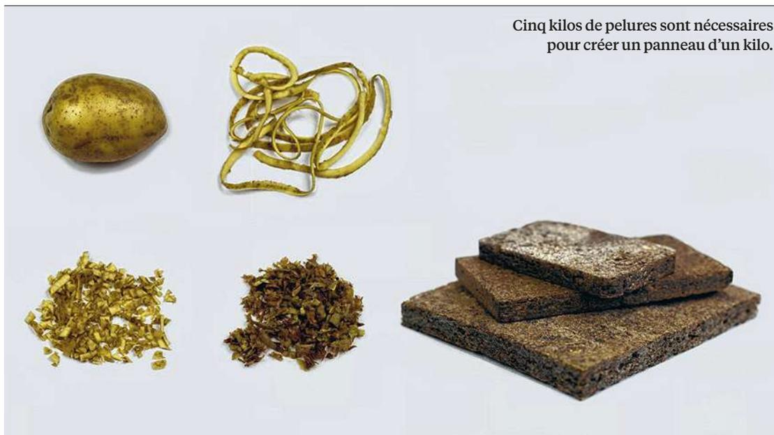
Cinq kilos de pelures sont nécessaires pour créer un panneau d'un kilo.
